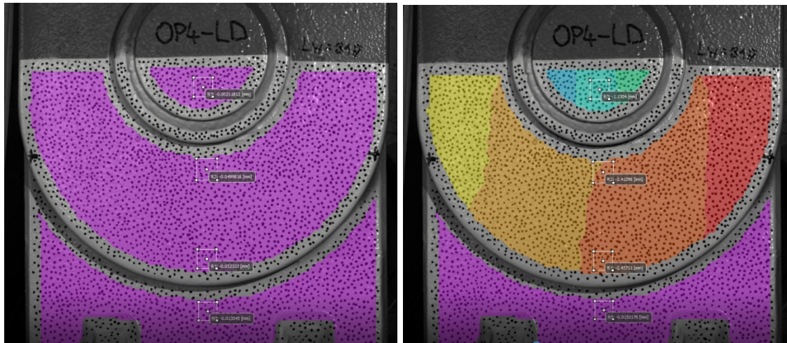
Obr. 7: Srovnání výsledků získaných aplikací DIC na čepch kotvení mostu ze stavu před a po zatížení mostu a ukázka vyhodnocených svislých deformací v ploše.
