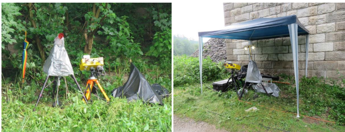
Obr. 6 – Dva radary IBIS-FS (vlevo) a IBIS-S (vpravo) umístěné pod nosnou konstrukcí ocelového železničního mostu přes řeku Sázavu v Ratajích.
