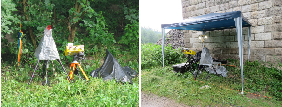
Obr. 2: Dva radary IBIS-S (vlevo) a IBIS-SF (vpravo) umístěné pod nosnou konstrukcí ocelového železničního mostu přes řeku Sázavu v Ratajích.
