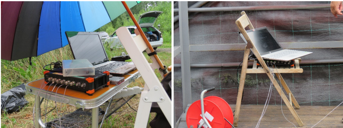
Obr. 15: Pohled na měřicí ústřednu Sirius 8ACC při experimentu na silničním mostu u Pelhřimova v roce 2022 (vlevo) a na měřicí ústřednu Sirius 6ACC-2ACC+ při experimentu na železničním mostu v Ratajích v roce 2021 (vpravo).
