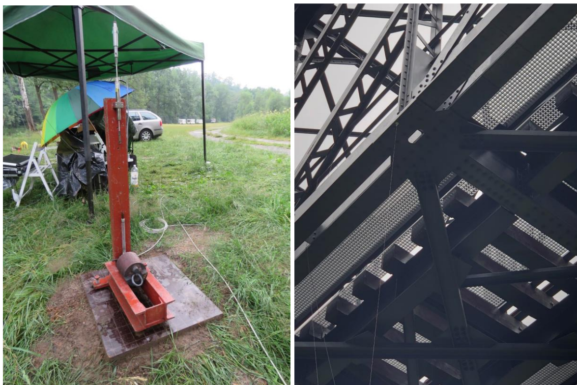
Obr. 8 – Relativní snímač dráhy (vlevo) a uchycení struny na dolním pasu hlavního nosníku (vpravo).
