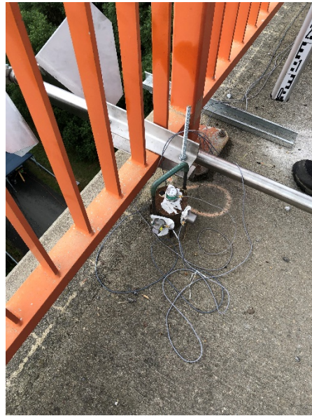
Obr. 14: Pohled na tři absolutní snímače zrychlení 8344 umístěné ve sledovaném bodu na železničním ocelovém mostu v Ratajích (vlevo) a na silničním betonovém mostu u Pelhřimova (vpravo).
