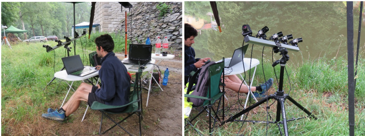
Obr. 9: Kamery upevněné na stativu při experimentu na ocelovém železničním mostu v Ratajích.
