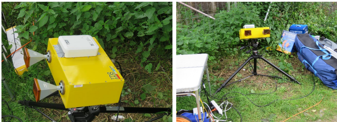
Obr. 3: Radar IBIS-SF s upevněným inklinometrem Statotest při měření na ocelovém železničním mostu přes řeku Sázavu v Ratajích v roce 2021.
