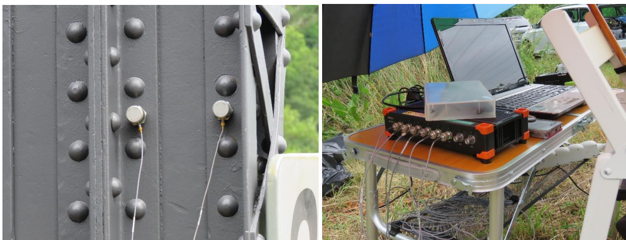
Obr. 9 – Dva absolutní snímače zrychlení 8344 při experimentální modální analýze (vlevo) a dynamická měřicí ústředna Sirius 8ACC (vpravo).
