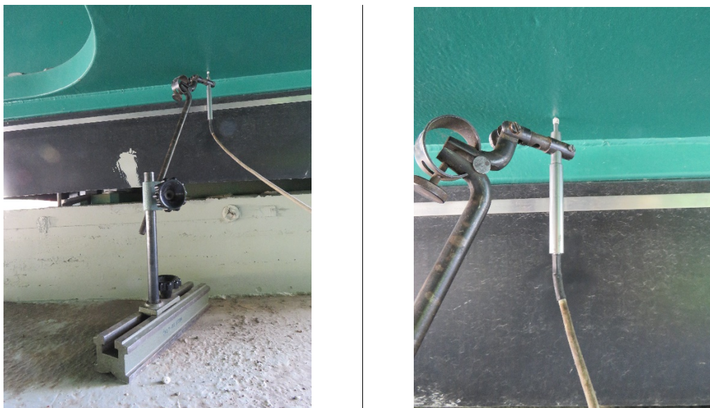
Obr. 16: Pohled na uspořádání měření svislého zatlačení ložiska relativním snímačem dráhy při statické zatěžovací zkoušce železničního mostu v Púchově, celkový pohled (vlevo) a detailní pohled na indukční snímač dráhy s odpruženým hrotem DTA-1G-CA vyrobený firmou Micro-Epsilon (vpravo).
