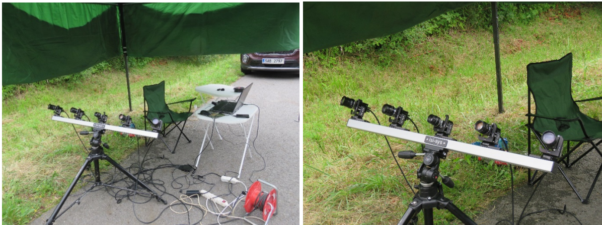
Obr. 8: Kamery upevněné na stativu při experimentu na betonovém silničním mostu u Pelhřimova.
