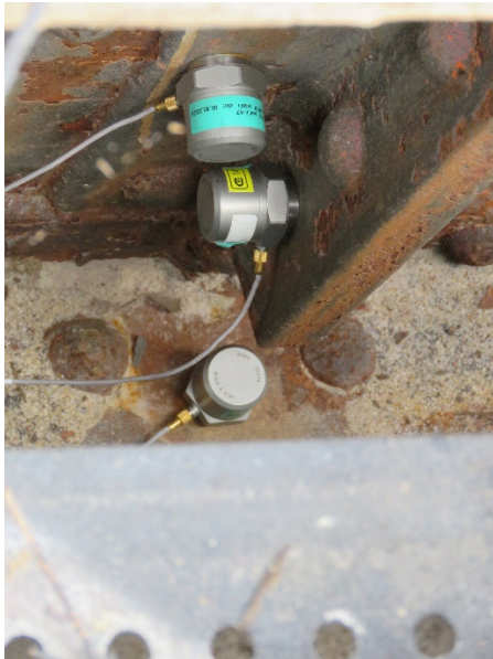
Obr. 14: Pohled na tři absolutní snímače zrychlení 8344 umístěné ve sledovaném bodu na železničním ocelovém mostu v Ratajích (vlevo) a na silničním betonovém mostu u Pelhřimova (vpravo).
